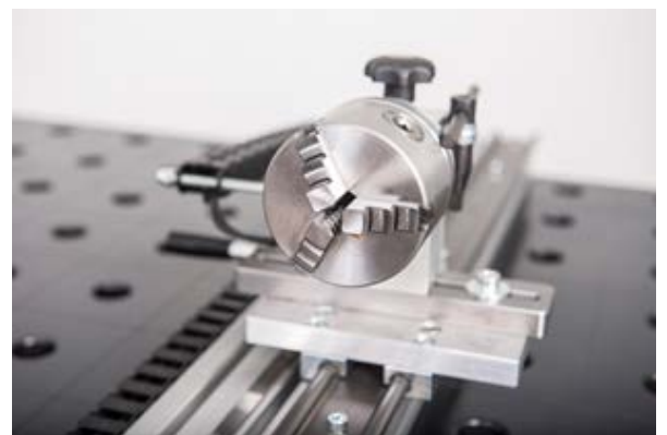
Laufwagen mit 3-Backenfutter Carriage with 3-point-chuck
