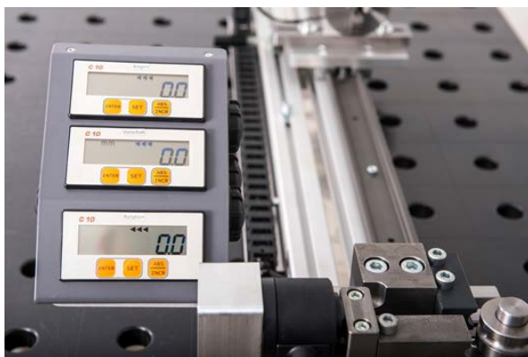
Digitale Anzeige von Länge, Verdrehung und Biegewinkel digital read-out of length, rotation and bending angle
